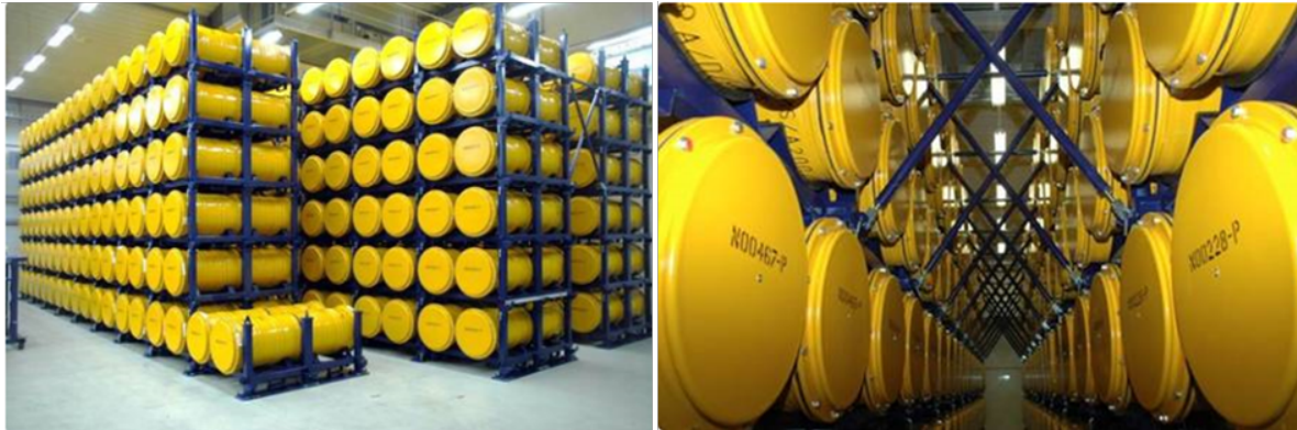
Abbildung 5: Zwischenlagerung der konditionierten 200 Liter-Fässer; Bilder: © NES GmbH
